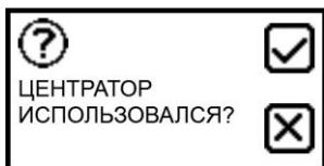
Устройство запросит, был ли использован позиционер для фиксации конструкции труба-фитинг в процессе сварки. Эта информация также будет отображена в протоколе.
