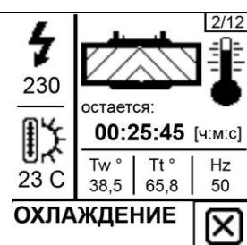
После успешного завершения процесса сварки, устройство начнет отсчет времени охлаждения.
