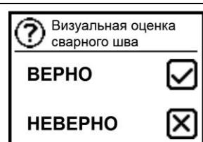
По завершении процесса охлаждения устройство запросит у оператора визуальное подтверждение выполненного соединения. Проверьте индикаторы расплава на фитинге и подтвердите наблюдения:
