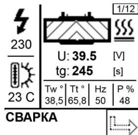
Электромуфтовая сварка в процессе. Экран отображает информацию о его текущих параметрах: оставшееся время сварки, напряжение и наружная температура, частота тока и процент использования трансформатора.
