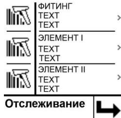
На следующем этапе программа попросит оператора ввести коды отслеживания фитинга и трубы.
