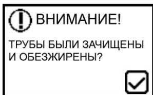
Устройство напомнит оператору о необходимости удаления оксидного слоя и последующего обезжиривания свариваемых элементов.
