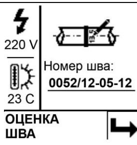
Последнее сообщение сварочного процесса отобразит номер сварки. Устройство назначит номер, которым оператор должен пометить трубу.
